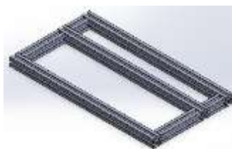
Figura 1 Modelo 3D de la base de perfil de aluminio
