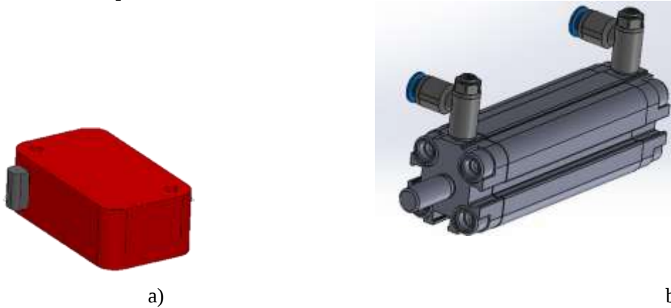
Figura 7 Piezas del primer ensamble a) sensor de detección de la celda b) actuador lineal de doble efecto
