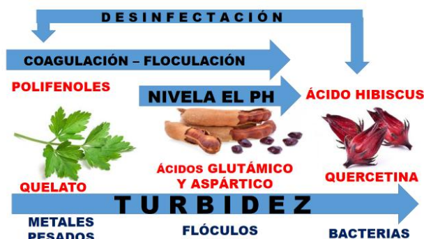
Figura 1. Proceso de purificación JaCiTa
